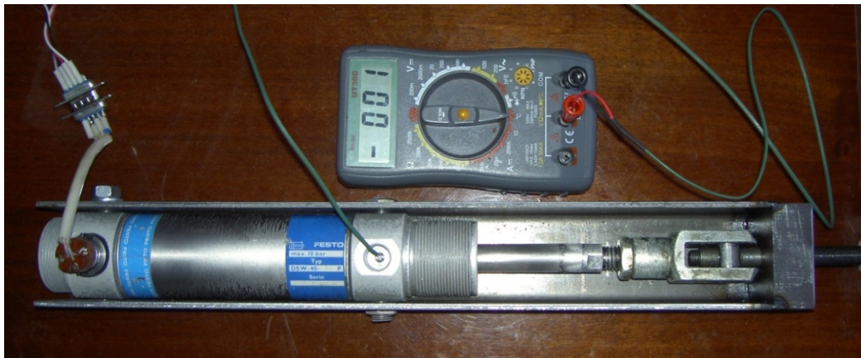
Фото 1 Пневмоцилиндр DSW-40-50P с установленным в нем преобразователем давления в специально изготовленном станке и мультиметр UT-30C с термодатчиком. (см. примечание * в конце статьи)
